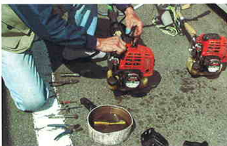
刈払機を当分の間使用しない時は、タンクと気化器から燃料を抜いて、さらにエンジンが停止するまで運転します。最後にプラグの穴からオイルをたらし、エンジン内にオイルを行きわたらせておきます
