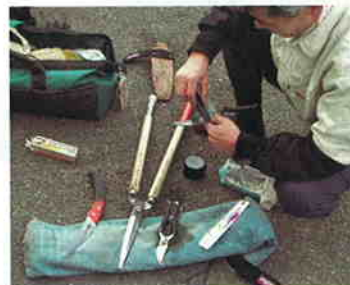
剪定バサミなど工具類を研磨したり、周動部には潤滑剤塗布など、手入れを怠りません
